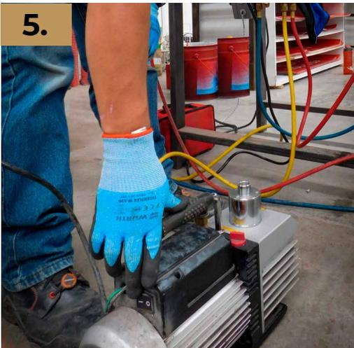
Una vez alcanzados los 500 micrones de vacío, se procede a cerrar los manómetros, se abre el gas ballast, y cuando cambie de sonido en la bomba se puede apagar
