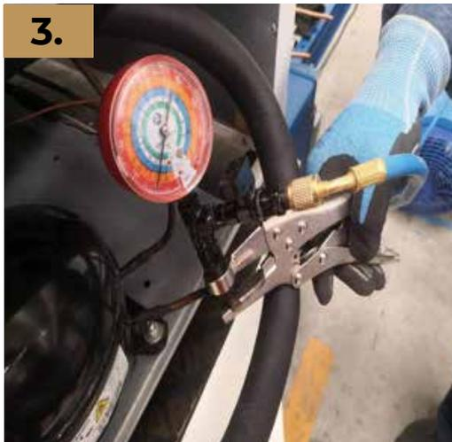
Accionar pinza punzante para liberar el refrigerante hidrocarburo del sistema de refrigeración, y regular la salida del refrigerante con el manifold
