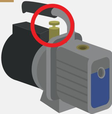
Se conecta la bomba de vacío al sistema de refrigeración, con la manguera de 3/8 conectada a la bomba de vacío. De esta manera el vacío se genera más rápido y de forma más adecuada.
