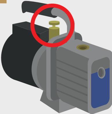
Conectar la manguera del manómetro a la bomba de vacío, deberá estar encendido el ventilador ATEX y de igual modo el detector de refrigerante inflamable
