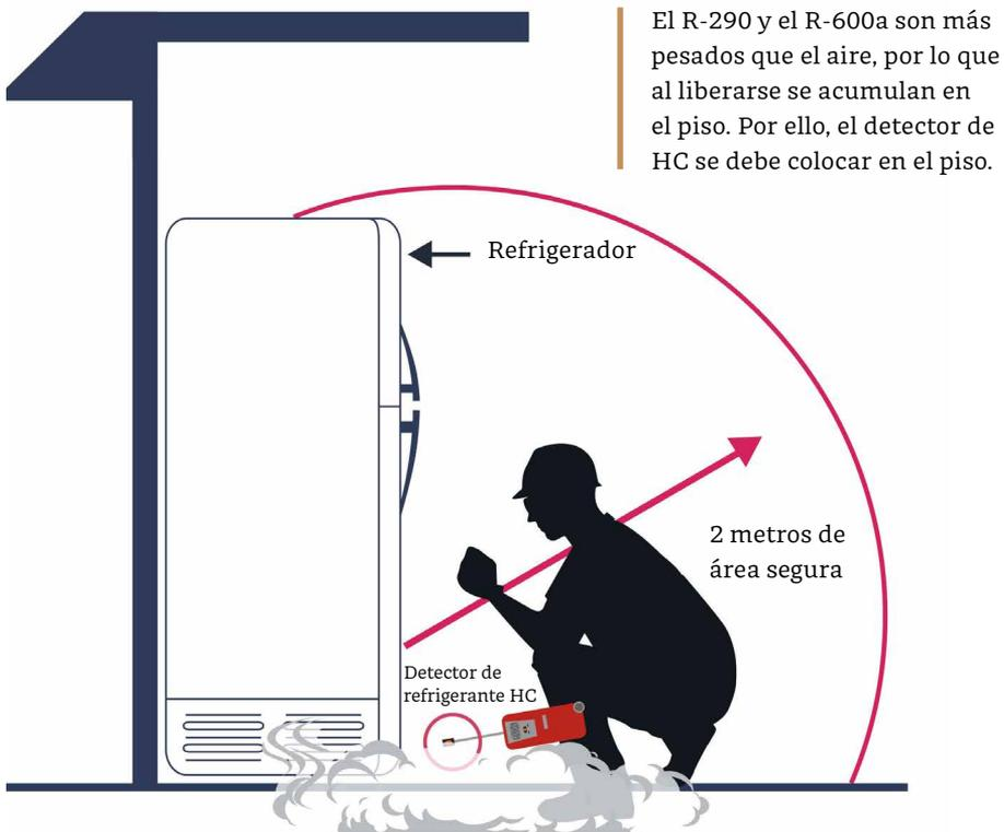
Ilustración 8. Área segura para refrigerador
