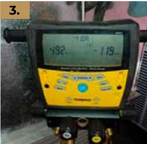
Con la ayuda de un vacuómetro se realiza un vacío a 500 micrones
