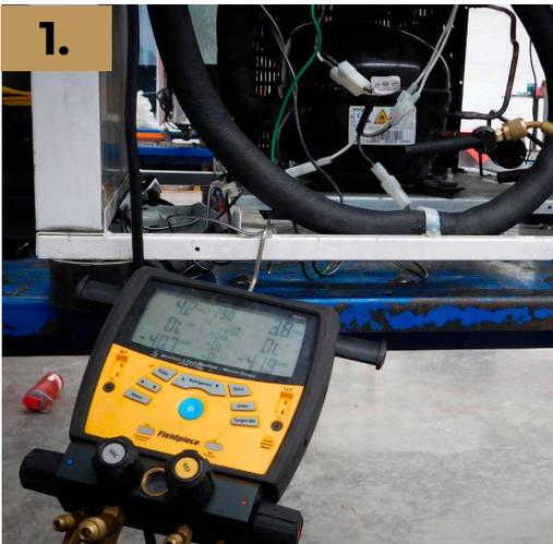
Se conectan las mangueras del manómetro en la válvula de servicio del filtro deshidratador y del compresor
