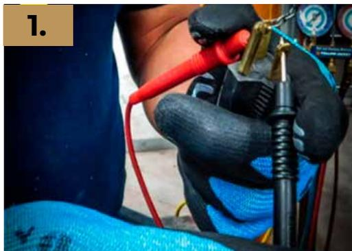
1. Revisar la continuidad entre las terminales de la clavija con conector de tierra de cable de servicio. De existir continuidad entre la terminal del conector, se procede a verificar que no exista exposición de cobre haciendo contacto con alguna superficie del equipo. De existir exposición de cobre, se procede a realizar el cambio de cable de servicio
