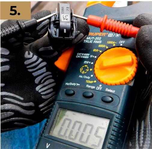
Se revisa la continuidad en el relevador electromagnético, colocando las puntas del multímetro entre las terminales 2 y 3 del relevador. Si no existe continuidad, se procede a realizar el cambio de relevador electromagnético. De existir continuidad, se procede a realizar la revisión del capacitor electrolítico de arranque
